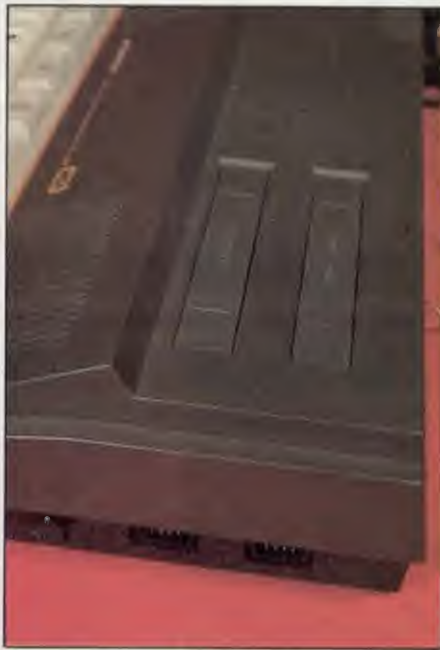
Conexión doble para cartuchos ROM del Sanyo.
